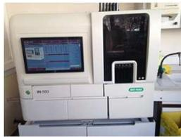
Calcul automatisé des scores (Marsh) dans le SGL du laboratoire à partir des cotations faites Par le logiciel de l'IH-500
